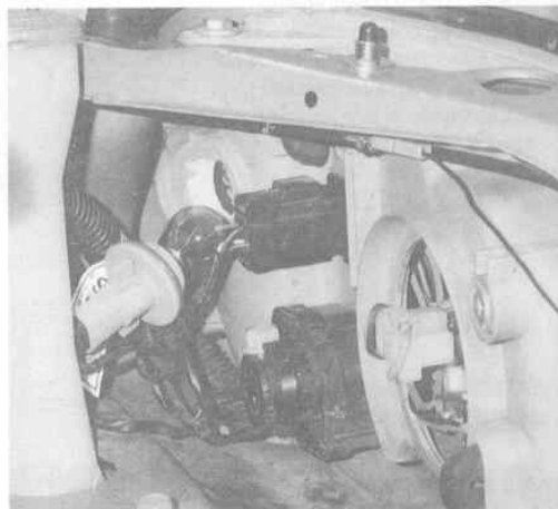
WYMIANA ŻARÓWKI KIERUNKOWSKAZU PRZEDNIEGO
