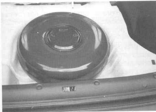
ZBIORNIK TOROIDALNY (pod pokrywą centralną umieszczony wielozawór)
